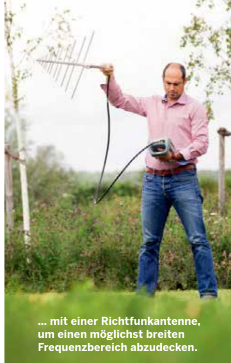
Hochfrequenz-Elektromog misst Baufritz sowohl mit einer bikonischen als auch ...
