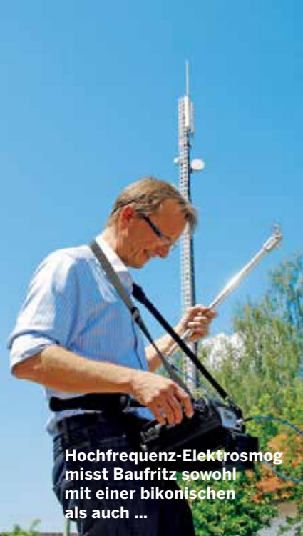
... mit einer Richtfunkantenne, um einen möglichst breiten Frequenzbereich abzudecken.
